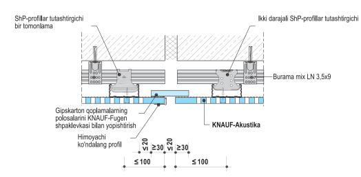
Osma shiftning har 15 metriga va yuk koïtaruvchi konstruksiyalarning deformatsion chokli joyiga deformatsion chok tushiriladi
